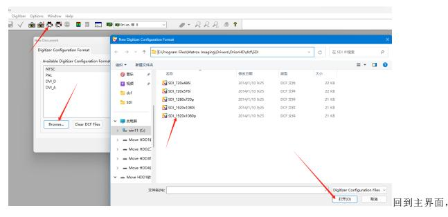
打开相机电源,次点击箭头所示图标,选中路径下的 SDI\_1920x1080P 这个 DCF,点击打开,此时弹出错误
